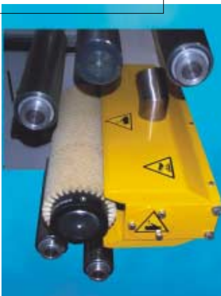
NPH-P varmperforeringsenheden er til perforering af plastfolier, hvor hulkvaliteten skal være specielt høj.
