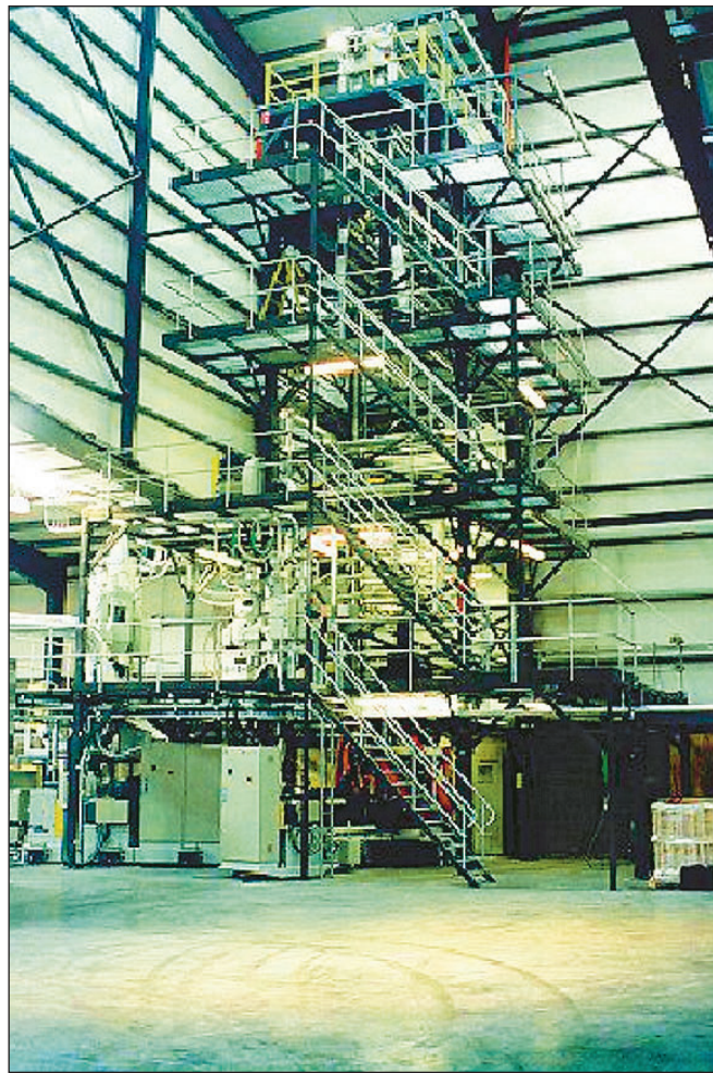
Før en blæst plastfolie kan spoles op skal den være kølet tilstrækkeligt ned. Her et eksempel fra en stor plastfabrik, hvor maskinfabrikken har konstrueret og opstillet gelændere og platforme, som skal anvendes i forbindelse med opspoling af folien.
